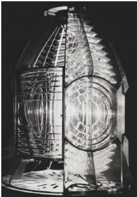
De optiek van het hoge licht van Hoek van Holland uit 1960, in de vuurtoren op de Maasvlakte Bron: https://kustverlichtingsmuseumhoekvanholland.nl/het-hoge-licht-van-de-uitgaande-lichtenlijn/
