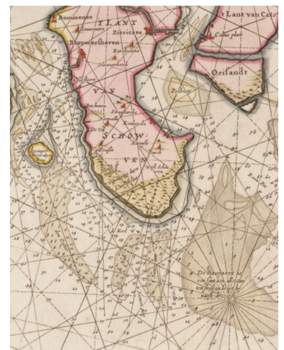
Fragment van een paskaart uit 1666 met daarop de zichtlijn van twee kapen en de lichtenlijn van twee vuurboeten.
