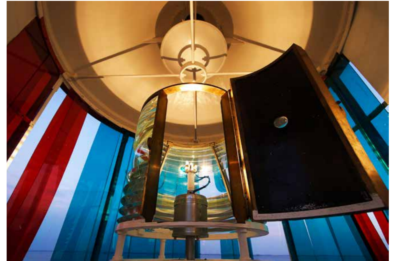
De oude optiek van het havenlicht van Vlissingen, met rondom gekleurde sectoren. Foto Guus Mahler.
