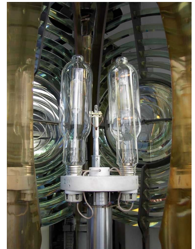
Lampenwisselaar met kwikjodidelampen.
