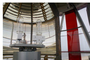
De huidige optiek met een lampenwisselaar met halogeenlampen.
